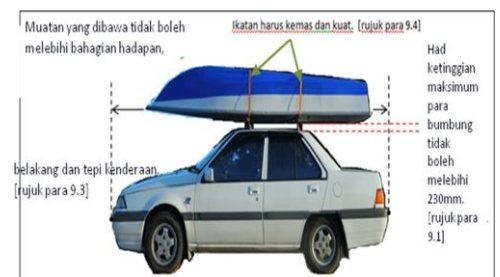
Pemasangan para bumbung dan kaedah muatan pada para bumbung
